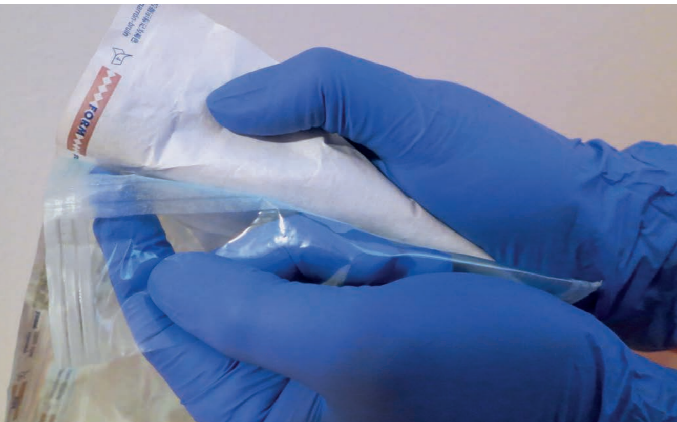
Fig. 3: peel test 剝離測試。
