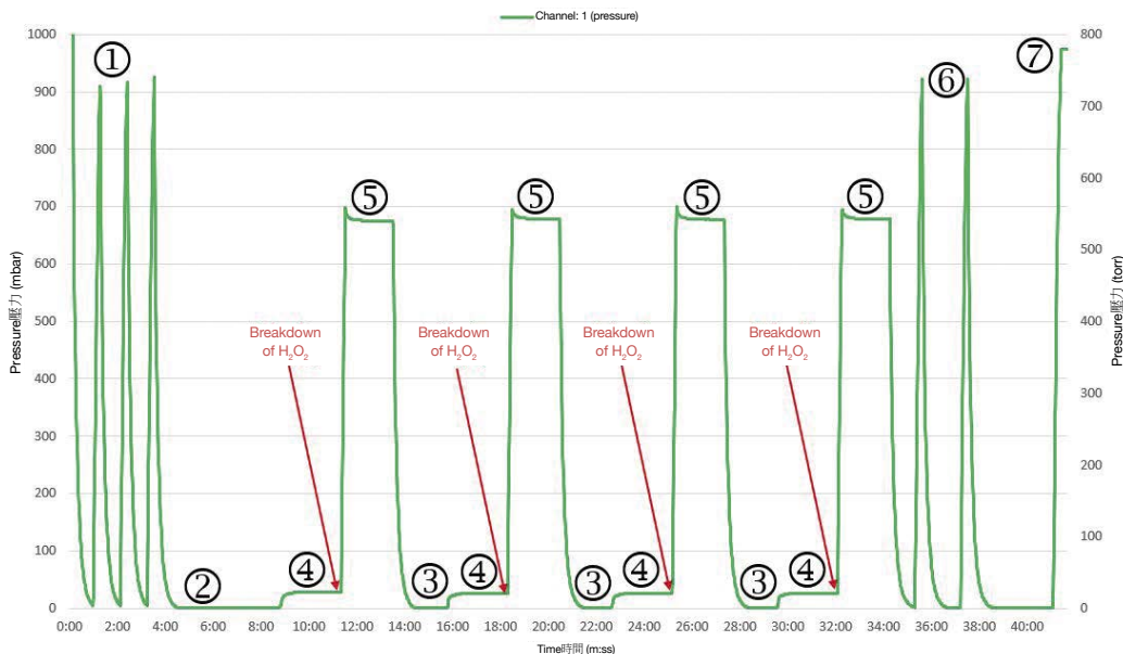
Pressure chart VH 2 O 2 Flex programme in Steelco PL 130 VH 2 O 2 Flex 程序在 Steelco PL 130 的壓力表
