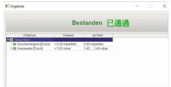
Figure 2: Automatically generated vacuum test in accordance with E DIN EN 17180; appendix D 6.24, result with ebro Winlog.validation / Winlog.med analysis software. 根據 E DIN EN 17180 自動生成真空測試；附錄 D 6.24，使用 ebro Winlog.validation / Winlog.med 分析軟件得出的結果。
